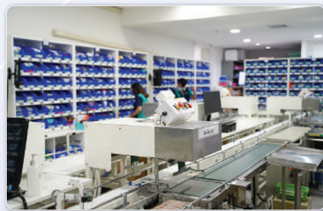
ระบบไฟนำทาง (LED) จะทำงานร่วมกับระบบสายพาน เพื่อปัดตะกร้ายาไปยังโซนที่ต้องจัดยา
