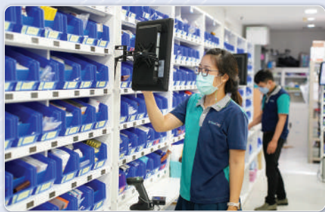
การจัดยาด้วยระบบไฟนำทาง (LED)
